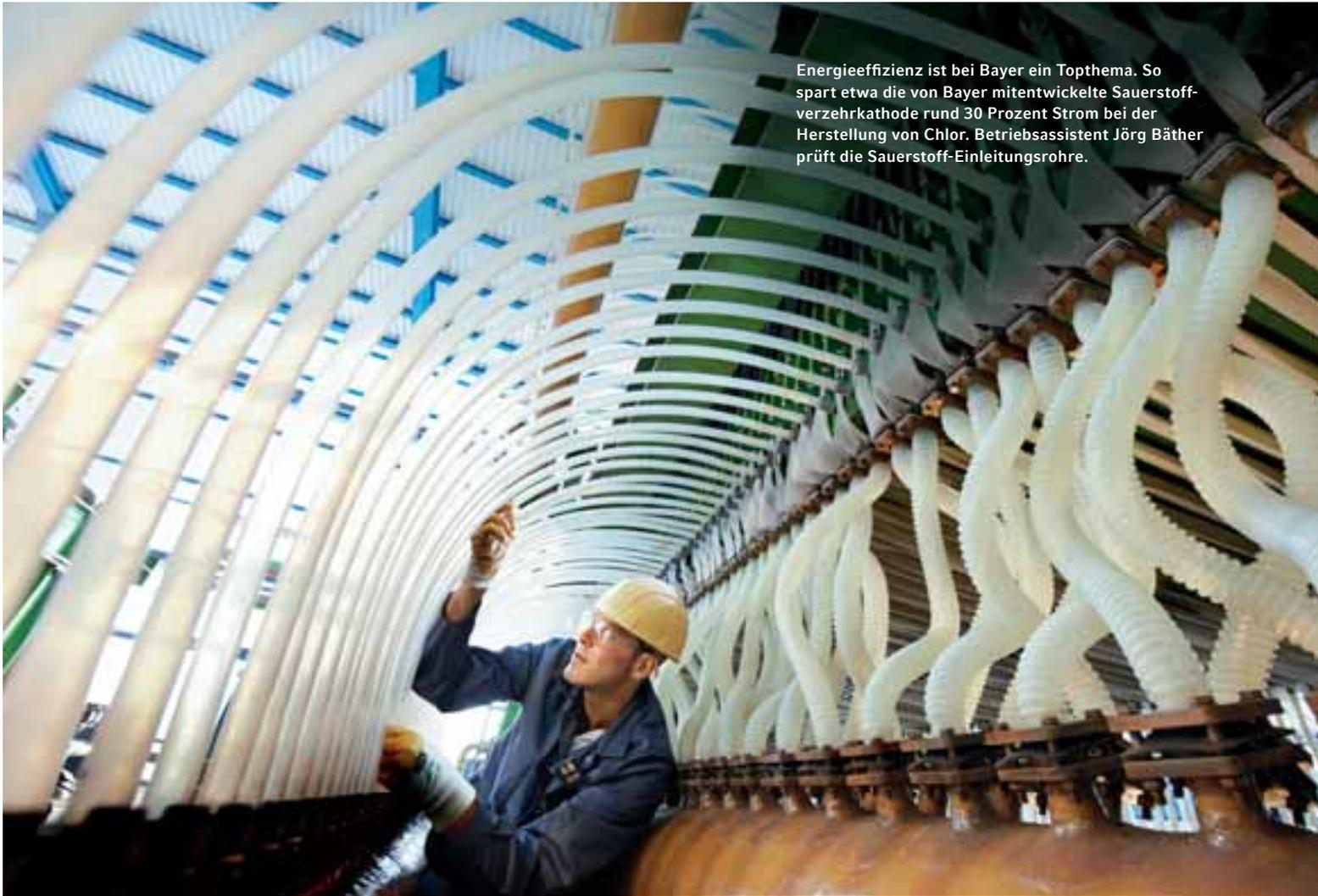
Energieeffizienz ist bei Bayer ein Topthema. So spart etwa die von Bayer mitentwickelte Sauerstoffverzehrkathode rund 30 Prozent Strom bei der Herstellung von Chlor. Betriebsassistent Jörg Bätger prüft die Sauerstoff-Einleitungsrohre.
