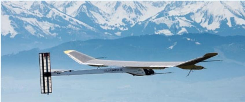
Der Prototyp mit 12.000 Solarzellen. Für die Nacht wird Energie in Batterien gespeichert.
