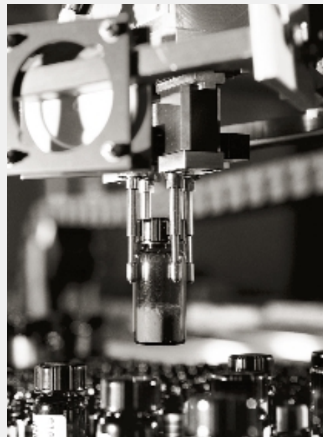
In der Bayer-eigenen Substanzbibliothek in Wuppertal lagert eine halbe Million Prüfsubstanzen (Foto rechts). Der Screening-Roboter (Foto oben) kann pro Tag bis zu 200.000 Substanzen auf ihre Wirksamkeit testen.
