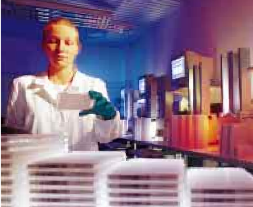
Im Pharma-Forschungszentrum in Wuppertal werden so genannte Mikrotiter-Platten mit Testsubstanzen befüllt und im High-Throughput-Screening-Roboter auf ihre Wirksamkeit geprüft. Das Foto zeigt Marina Breuhaus beim Sichten und Sortieren solcher Platten.
