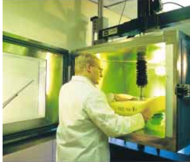
Foto links: Die Qualität eines Schaumstoffs wird auf Lebensdauer und Haltbarkeit bei Hitze und Feuchtigkeit getestet. Auf dem Foto oben wird ein Polyol-Rohstoff als neues Basisprodukt für Autositze raffiniert.
