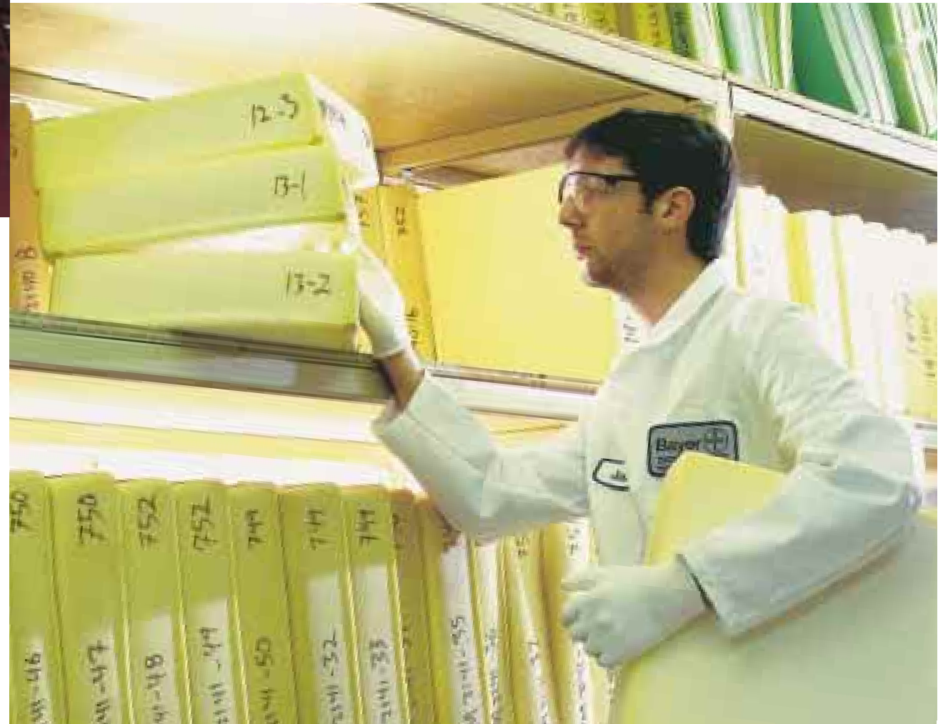
Wie in einer „Bibliothek“ lagern – akribisch beschriftet und katalogisiert – Schaumstoff-Blöcke 24 Stunden lang zum Trocknen. Danach wird in zahlreichen Tests untersucht, ob sie den vorher festgelegten Anforderungen der Kunden entsprechen.
