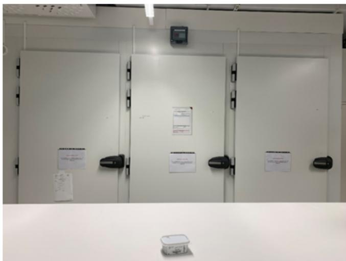
Élément fondamental dans cette première étape de l'analyse de résidus : la stabilité au froid. Le poids de l'échantillon doit être le même avant et après la congélation, jusqu'à son analyse.
