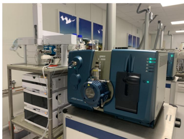
Les spectromètres de masse couplés à la chromatographie liquide (LCMS) sont les machines qui mesurent la quantité de résidus. Ces machines hautement spécifique et ultra-sensibles également qualifiées isolent puis pèsent les molécules (produit parent et ses métabolites) que l'on souhaite quantifier.
